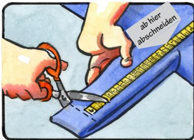
Die Hälfte der genommenen Länge aufmarkieren und die Gewebeschläuche dementsprechend kürzen.
